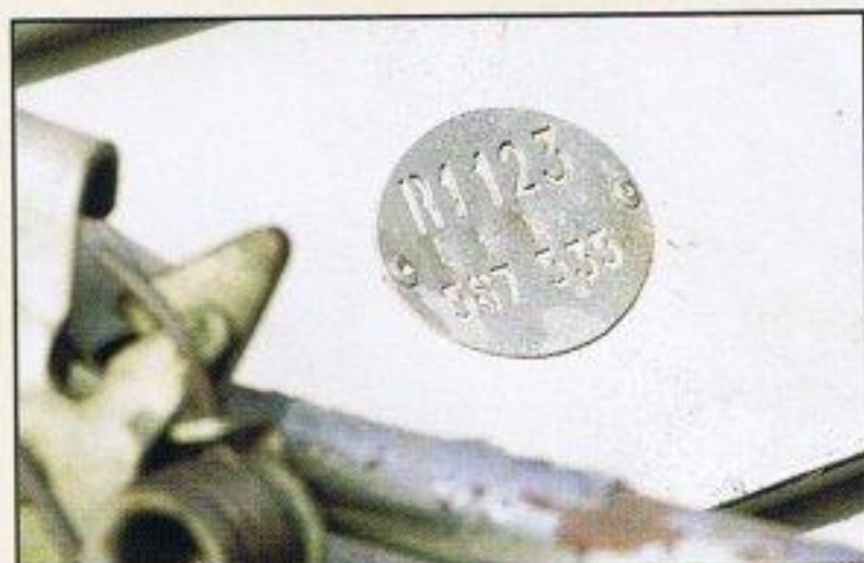
Le type R1123 correspond à la motorisation 5 CV fiscaux et 845 cm 3 ...
