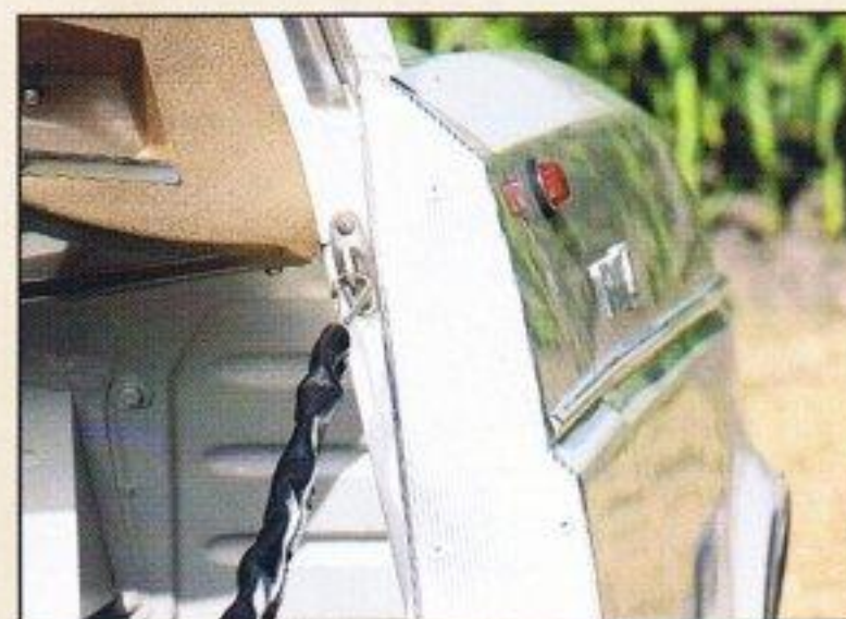
La découpe est habillée par des plaques d'aluminium strié. Des éléments souvent abîmés...
